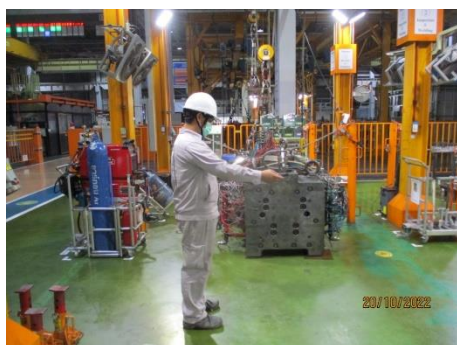
ภาพที่ 3-4 การตรวจวัดแสงสว่างในสถานที่ทำงาน (Working Area)
